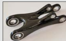
Nejvyšší model řady Score dostal pro příští sezonu karbonové spojovací rameno u tlumiče. Oproti původní prohnuté příhradové verzi vypadá lépe a mělo by i nabídnout vyšší pevnost. Navýšení torzní tuhosti by se ostatně mělo týkat všech karbonových rámu Score.
