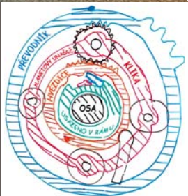
Původní náčrt prvotního nápadu funkce HammerSchmidt
