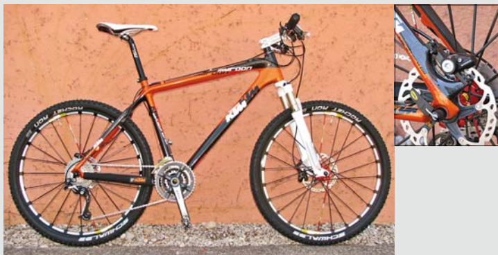
Myroon nahrazuje biky série Team LC a hmotnost jeho celokarbonového rámu se konstruktérům podařilo stlačit pod jeden kilogram. Torzní tuhost je přítomná na skvělé úrovni, což potvrdil i náš praktický test. Na tomto rámu není problém postavit bike vážící výrazně pod jeden kilogram. Postmount uchycení třmenů zadní brzdy vypadá fantasticky.
