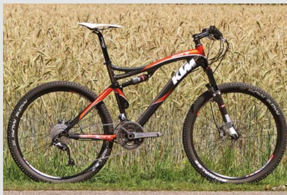
Nejvyšší model řady Score dostal pro příští sezonu karbonové spojovací rameno u tlumiče. Oproti původní prohnuté příhradové verzi vypadá lépe a mělo by i nabídnout vyšší pevnost. Navýšení torzní tuhosti by se ostatně mělo týkat všech karbonových rámu Score.
