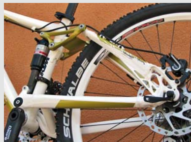
Typ Lycan je určen především maratoncům a všem jezdčům, vyžadujícím od stroje „terénní univerzitu“. Zdvih 120/120 mm, plovoucí uložení tlumiče, maximální tuhost předního trojúhelníku i zadní stavby. Už se těšíme, až tuto novinku otestujeme.
